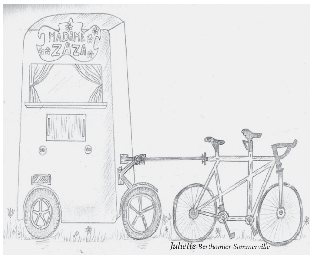
Croquis 2 : la caravane construite sur le modèle de remorque "charette" tractée ici par un tandem.
